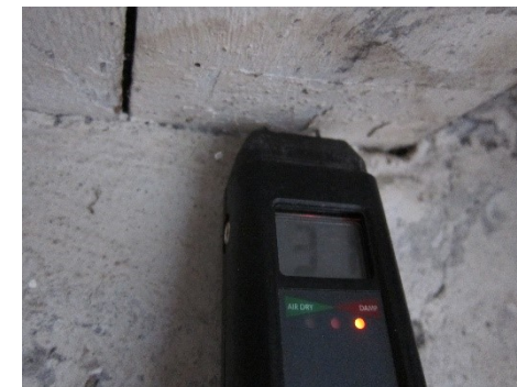
Fugtmåling i vinduesoverligger 31 %
