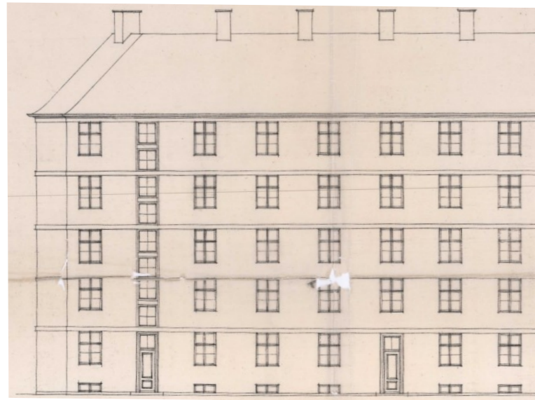
Oprindelig facade - inddeling af vinduer
